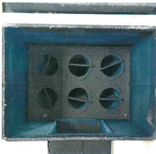
Rysunek 9 Wymiennik pionowy z zawirówkami
